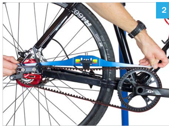
接触两个齿盘，测量跨距的皮带张力。
